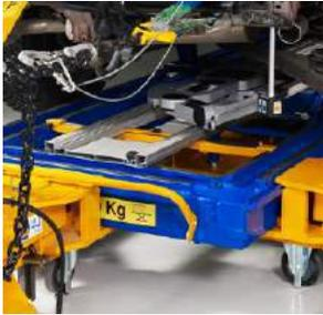
Car-O-Tronic 放置在測量長尺上並可來回移動在測量長尺軌道中的細微標記能夠使Car-O-Tronic下的測量頭識別其相對應的水平位置。
